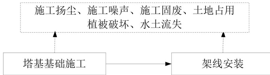
图 2.1 送出工程施工期工艺流程及主要产污环节
